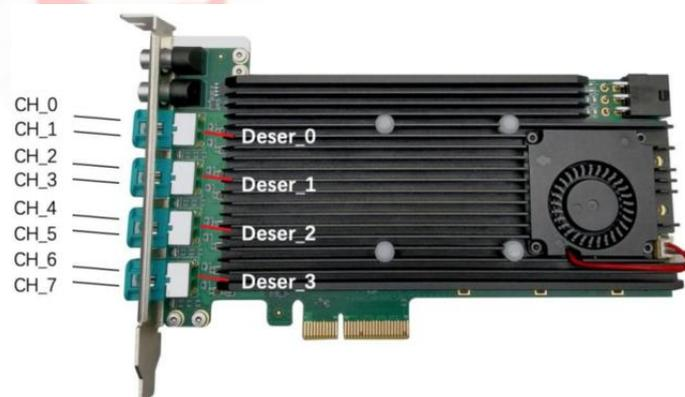
图 3-5 艾利光 PCIE 视频采集卡
